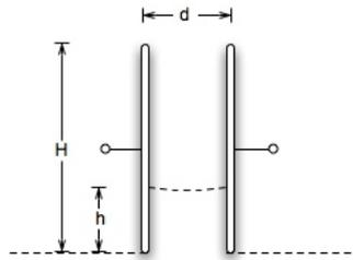
Man kann sich den Kondensator als eine (parallel geschaltete) Zusammensetzung von zwei Kondensatoren der Breite  $l$  und jeweils der Höhe  $h$  und  $H - h$  vorstellen.
