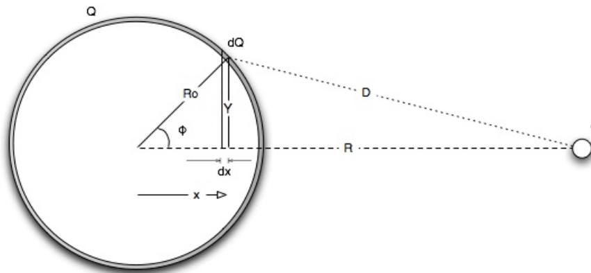
Zu jedem *Schritt*  $dx$  im Abstand  $x$  vom Kugelzentrum gehört ein Ring-Segment mit dem Radius  $Y$  und der Ladung  $dQ$  auf der Kugelschale.
