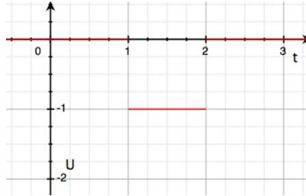
Es wird also nur eine Spannung induziert solange der Rahmen noch *am Eindringen* ist. Dann ergibt sich der entsprechende Strom  $I$  als
