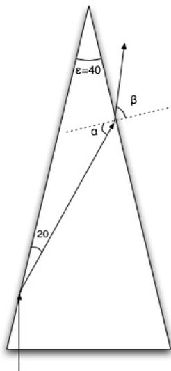
Durch geometrische Überlegungen kommt man auf  $\alpha = 30^\circ$ . Da  $\sin \beta = n \sin \alpha$  folgt dass  $\beta = 45^\circ$  und der Abweichungswinkel  $\gamma = 25^\circ$  sind.
