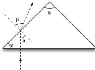
Der Auslenk-Winkel ist gegeben durch  $\gamma = \beta - \alpha$ . Aus dem Bild liest man ab  $\alpha = \varepsilon$ . Aufgrund des Snelliousschen Brechungsgesetzes gilt  $\sin \beta = n \sin \alpha = n \sin \varepsilon$ , also
